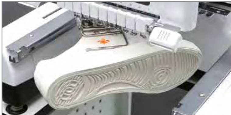
Установка обуви большого размера
