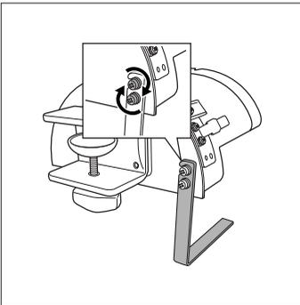
**2 Ziehen Sie die beiden Schrauben an.**
