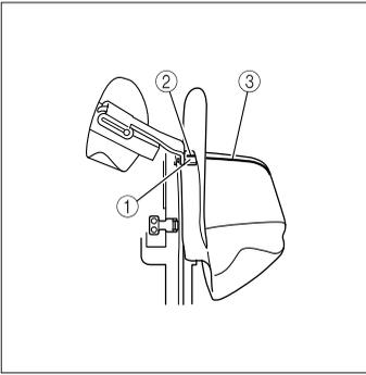
Richten Sie gleichzeitig die Mittellinie der Mütze gegen die Mittellinie des Schweißschutzhalters am Kappenrahmen aus, und schieben Sie den Schweißschutz unter den Schweißschutzhalter.
