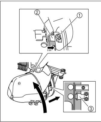
Nachdem Sie den Kappenrahmen so gedreht haben, dass die Stickfläche nach oben zeigt, richten Sie den Ring des Kappenrahmenantriebs und den Ring des Kappenrahmens gegeneinander aus. Schieben Sie den Kappenrahmen nach rechts und links, um die Kerbe am Kappenrahmen gegen die Führungsplatte am Kappenrahmenantrieb auszurichten, und rasten Sie den Rahmen ein.
