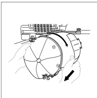
Drehen Sie die Stickposition beim Entfernen des Kappenrahmens zur Seite, damit die Krempe der Mütze nicht gegen die Stickmaschine stößt (siehe Abbildung).
