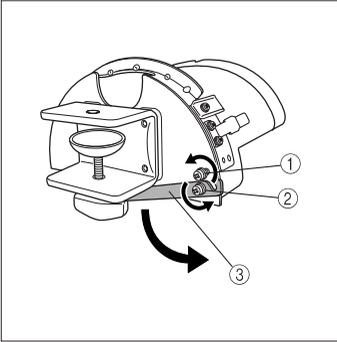
**1 Lösen Sie die beiden Schrauben mit einem Kreuzschlitz-Schraubendreher, und senken Sie den Nadelanschlag in Pfeilrichtung ab.**
