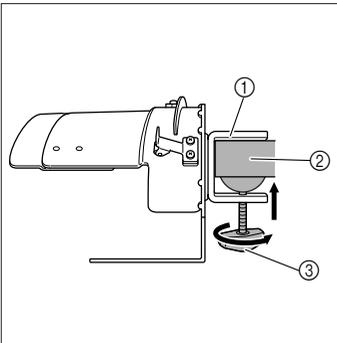
**4 Klemmen Sie die Schraubzwinge sicher an die Montagefläche, und ziehen Sie dann die Schraube an.**
