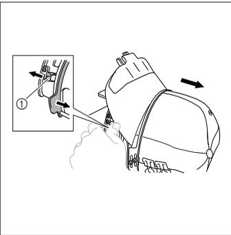
**15 Entfernen Sie den Kappenrahmen von der Montagevorrichtung.**
