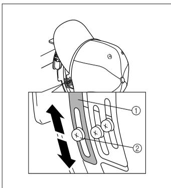
● Wenn der Stoff der Kappe zu dick ist und der Klemmrahmen nicht geschlossen werden kann, oder wenn der Stoff dünn ist und die Kappe zu locker im Rahmen ist, lösen Sie die Schraube für das Innere des Klemmrahmens, und stellen Sie dann das Innere des Klemmrahmens ein.
