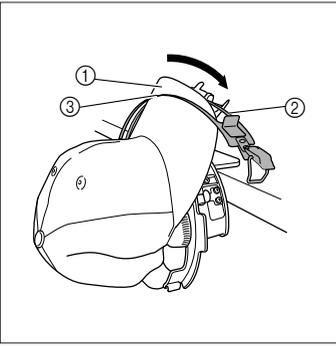
**7** Schließen Sie den Klemmrahmen so, dass die Krempe der Kappe zwischen der Innenseite des Klemmrahmens und der Außenseite des Klemmrahmens liegt.
