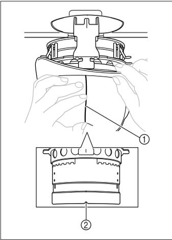
**5** Richten Sie die Mittellinie der Kappe mit der Kerbe in der Montagevorrichtung aus.
