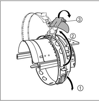
**2** Lösen Sie das Schnappschloss am Kappenrahmen, und entriegeln Sie es. Öffnen Sie den Klemmrahmen. Öffnen Sie außerdem den Krempehalter.
