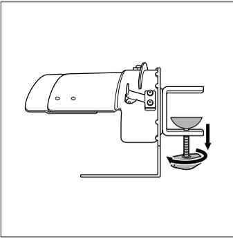
**3 Lösen Sie die Schraube für die Montagevorrichtung, und öffnen Sie dann die Schraubzwinge so weit, dass sie breiter als die Montageplatte ist.**
